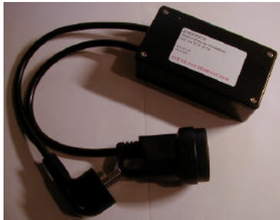
Figure 1.4 : Photographie d'un wattmètre
