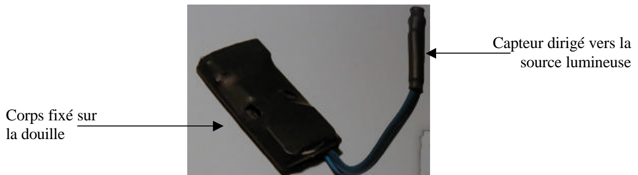
Figure 1.3 : Photographie d'un lampemètre
