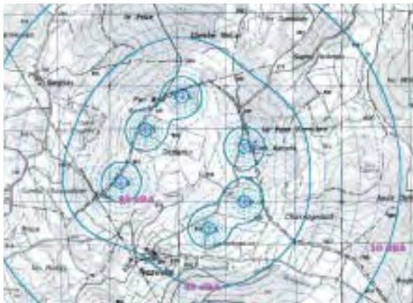
Figure 39 : Courbes isophones autour d'une centrale éolienne
