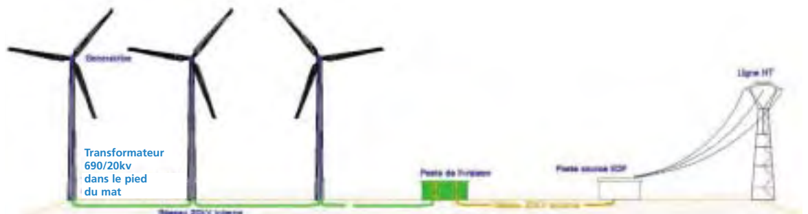
Figure : Représentation du raccordement d'un projet éolien
